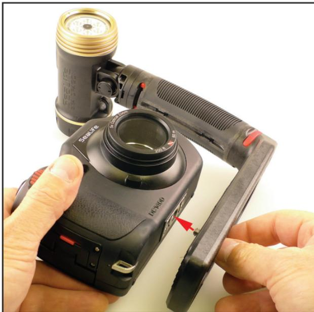
Führen Sie die Montageschraube der Leuchte in das Schraubloch der Kamera, und ziehen Sie sie mit der Hand fest.
